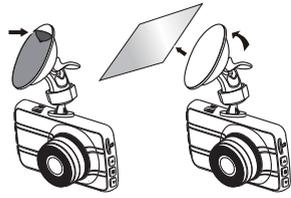
→ 鬆開旋鈕，將設備垂直或水平方向調整視角，旋緊旋鈕，確保設備已固定。
