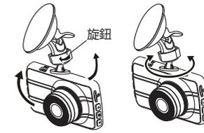
→ 水平方向轉動設備可進一步調整合適視角。
