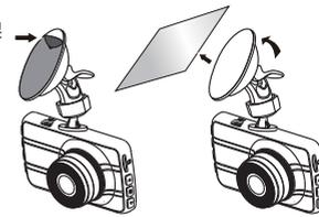
→ 松开旋钮，将设备垂直或水平方向调整视角，旋紧旋钮，确保设备已固定。
