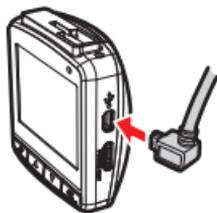
2. 将电源适配器的另一端插接汽车内的香烟点火器的插孔。汽车引擎一旦发动·设备即自动开机。车充输入直流电压 12/24V。
